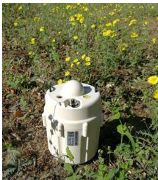
图 3 高精度无缆地震采集节点
